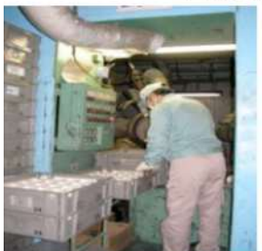
▲ 30インチロータリー羽布研磨機
