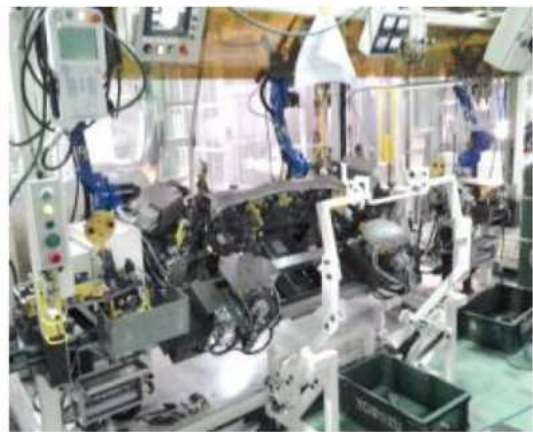
▲ アークロボット溶接装置
