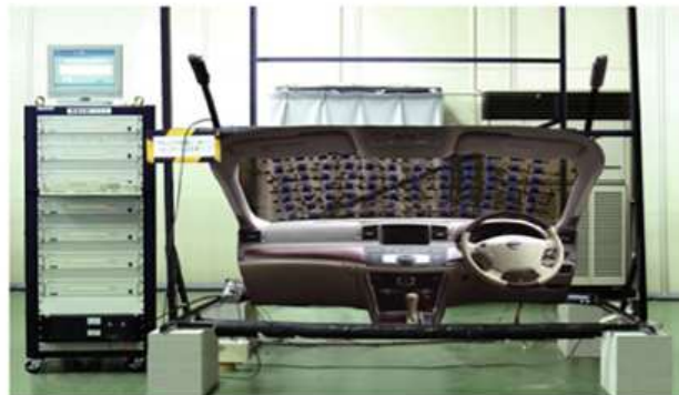
▲風速計測システム
